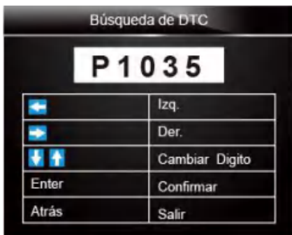
Figura 5-2 muestra pantalla de Búsqueda de DTC's (códigos de falla)
