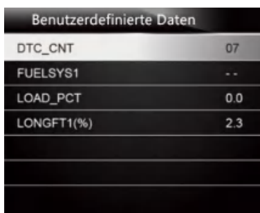
Abbildung 4-16 Beispiel Datastream Bildschirm
