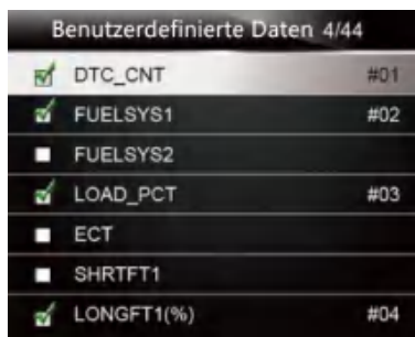
Abbildung 4-15 Beispiel Benutzerdefinierter Datastream-Bildschirm
